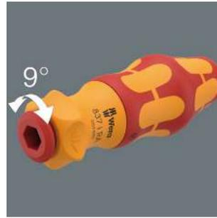
La carraca que viene integrada y que dispone de un dentado fino (40 dientes y un ángulo de retorno de 9°) facilita y acelera el trabajo de atornillar al no tener que volver a repositionar el útil constantemente de manera trabajosa.
