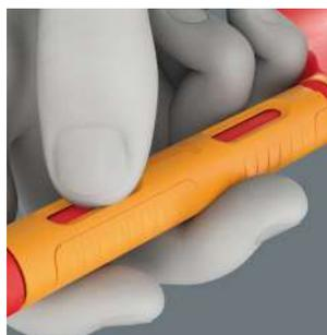
Las hendiduras en el manguito de giro libre permiten crear una resistencia por medio de la fuerza de los dedos. Esto permite utilizar el mecanismo de carraca incluso en los casos de poca resistencia al atornillar.
