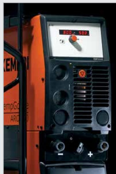
Una fuente de potencia móvil para tareas exigentes de torchado o resanado por arco-aire con electrodo de carbón. para el corte y la remoción de diversos tipos de metales.
