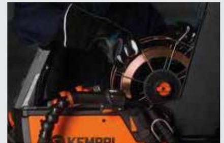
*El diseño del alimentador de carga superior garantiza la ergonomía y la seguridad a la hora de cambiar carretes de alambre de relleno pesados*
