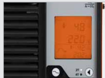
La función de relleno de cráteres reduce el nivel de voltaje al final de la soldadura y garantiza un control óptimo del arco hasta el final. El final del cordón es de una excelente apariencia y limpio, lo que facilita el inicio de la próxima soldadura sin que el soldador tenga que dedicar tiempo al esmerilado.
