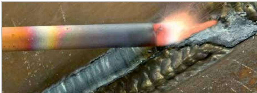
La KempGouge ARC 800 facilita el torchado o resanado por arco-aire con electrodos de carbón..
