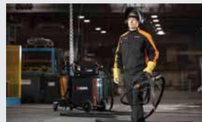
El subalimentador ligero es una alternativa ergonómica al transporte de alimentadores de alambre grandes y pesados, o a la soldadura con pistolas de retrotracción intensa que incrementan la presión en la muñeca del soldador.
