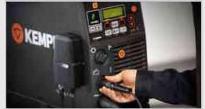
*El módulo de conectividad digital (DCM) es compatible de forma nativa con FastMig (incluido X5 FastMig) de Kemppi y las nuevas familias de productos MasterTig, además de otros modelos de equipos de soldadura o marcas usando los adaptadores WeldEye. X8 MIG Welder ofrece conectividad nativa con WeldEye, por lo que no se necesitan dispositivos adicionales.*
