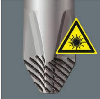
Con ayuda de rayos láser, se crea una estructura superficial de cantos afilados. Lasertip de Wera se aferra en la cabeza del tornillo como si tuviera dientes, y de este modo evita la salida indeseada del destornillador de la cabeza del tornillo durante la acción del atornillado. En tornillos ranurados, Phillips y Pozidriv.
