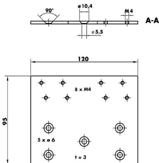
Placa para instalación vertical del retenedor en puertas cortafuego
