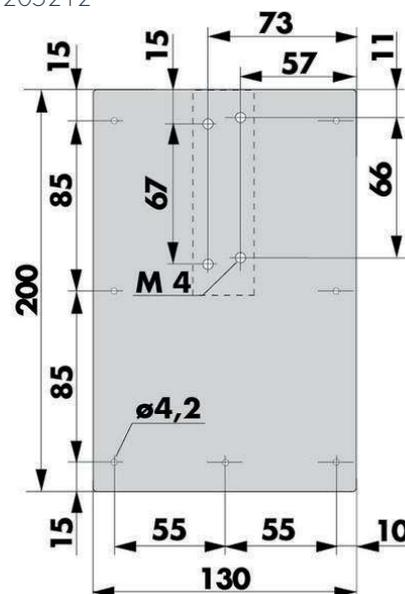
Placa para instalación vertical del gancho en puertas cortafuego
