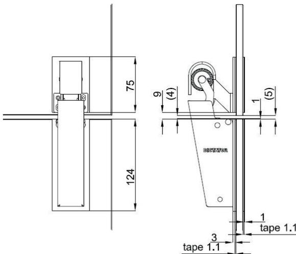
Con cinta adhesiva de doble cara especial, las placas de montaje del retenedor V 1600 y el gancho se fijan a la puerta/al montante de cristal. Cada set incluye una contraplaca adhesiva para el lado opuesto de la puerta para una imagen uniforme. Tanto las placas de montaje como la contraplaca son de acero inoxidable.
