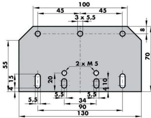
Placa para el retenedor en puertas cortafuego sin rebajo
